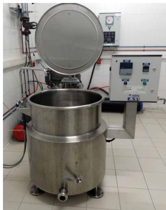
Pasteurisateur industriel : suivi des paramètres en continu, traitement plus homogène grâce à la double paroi alimentée par de la vapeur d'eau.
