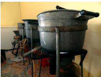
Équipement traditionnel de pasteurisation : marmite sur réchaud à gaz
