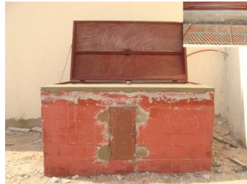
Fumoir en parpaing et grille utilisée comme support pour les poissons au cours du fumage
