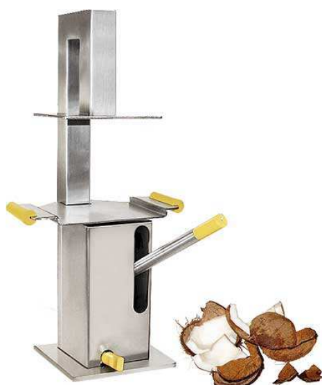
Figure 11. Equipement to break the shells of hard fruits ( http://www.meilleurduchef.com/cgi/mdc/1/fr/boutique/produits/lte-casse_noix_coco.html )
